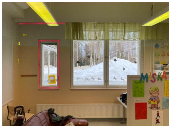
Kuva 52. Merkkiainekoe US 1. Merkkiainekokeessa havaitut merkittävät ilmavuodot on esitetty punaisella ja vähäiset ilmavuodot keltaisella.
