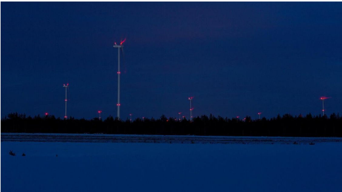
Kuva 9-4. Kiinteät punaiset lentoestevalot (Ville Suorsa, FCG).
