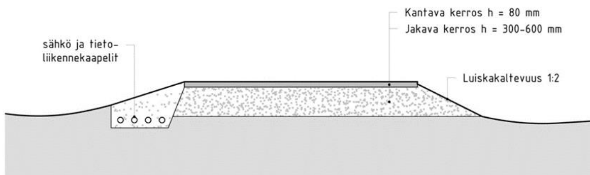
Periaatekuva uuden ja perusparannettavan tien rakenteesta.
