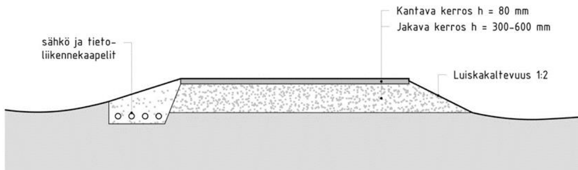
Periaatekuva uuden ja perusparannettavan tien rakenteesta.
