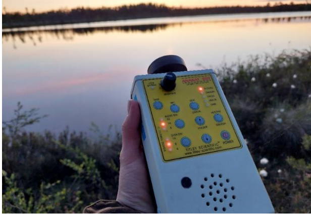
Kuva 5-1. Lepakkokartoituksessa käytetty Anabat SD2 -lepakkodetektor havaitsee lepakkojen kaikuluotausääniä muuttaen ne ihmiskorvin kuultavaksi.
