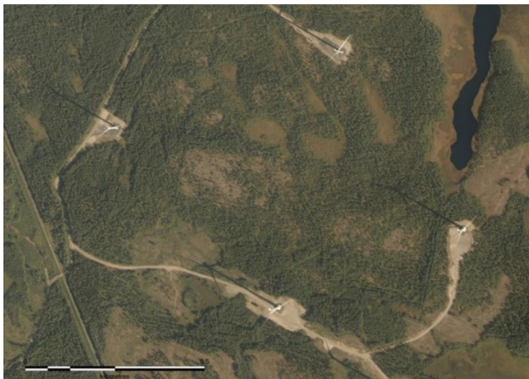
Kuva 9.1. Ilmakuvasssa näkyy toiminnassa olevia tuulivoimaloita. Tuulivoimaloita varten on rakennettu huoltotiet ja nostokentät. Tuulivoimaloiden ympäristössä ja välialueilla aikaisempi maankäyttö on säilynyt ennallaan (Maanmittauslaitos). Kuva ei ole Lylyharjun alueelta.
