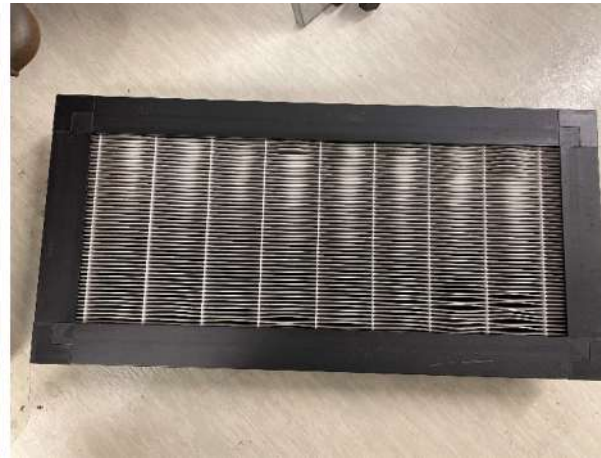
Kuva 273. Tuloilmansuodattimina on M6-luokan kasettisuodattimet.
