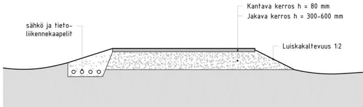
Periaatekuva uuden ja perusparannettavan tien rakenteesta.
