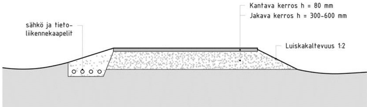
Periaatekuva uuden ja perusparannettavan tien rakenteesta.
